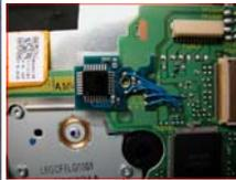
Montage possible avec sous sans les fils (quicksolder)
